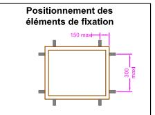
Ossature pour pose sur d'allège en structure
